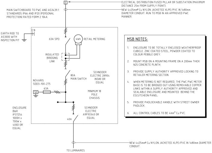
MSB SCHEMATIC DIAGRAM WITHOUT TIME CONTROL FOR UNDERGROUND STREET LIGHTING SCHEMES
